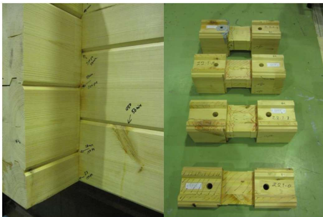
Obrázok B.4 – Vľavo: Označenie bodov prieniku vody a čas a tlak kedy prienik nastal počas skúšky vodotesnosti. Vpravo: Príklad označenia mokrých plôch na zrubových trámoch po rozobratí skúšobného telesa po skúške vodotesnosti
