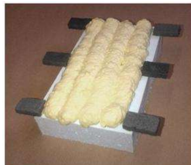
Obrázok C.2.3 – Osadenie s rozperkami (príklad 2)
