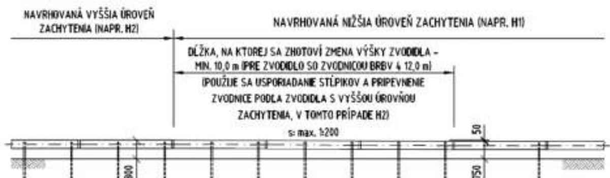
Obrázok 2: Príklad výškovej zmeny v napojení zvodidiel
