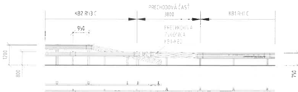
Obrázok 89: Príklad napojenia ocelového zvodidla KB2 RH3 a KB1 RH1 C
