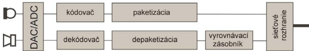
Obrázok A.1 – Prehľad rozličných funkcií implementovaných v koncovom zariadení VoIP
