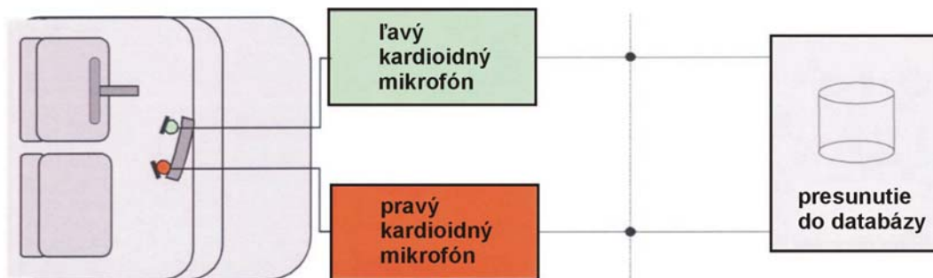
Obrázok 24 – Nastavenie na nahrávanie dvojicou kardioidných mikrofónov v autách
