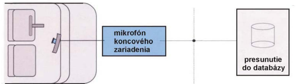
Obrázok 23 – Nastavenie na zaznamenávanie mikrofónmi koncového zariadenia v autách
