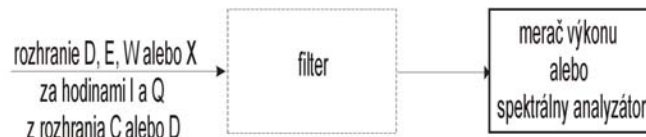
Obrázok E-14 – Meracia zostava na meranie výkonu šumu mimo prevádzky
