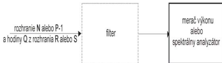
Obrázok B-7 – Skúšobná zostava nameranie úrovne signálu VF/MF
