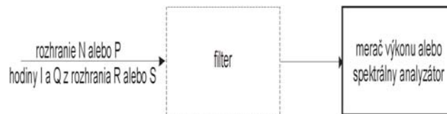
Obrázok B-8 – Skúšobná zostava alebo meranie úrovne šumu mimo prevádzky
