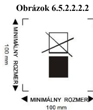
Nádoba IBC nevhodná na stohovanie
