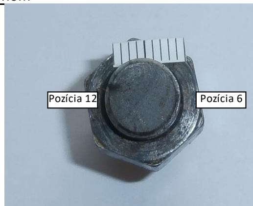
Obr. 1. Miesta odberu vzoriek. Orientácia odbemých miest pre analýzu porušenia celistvosti časti skrutky kola podvozku lietadla PPN DA-20, OM-KLL. Pozícia 12 – orientácia smerom hore, pozícia 6 – miesto kontaktu s terénom
