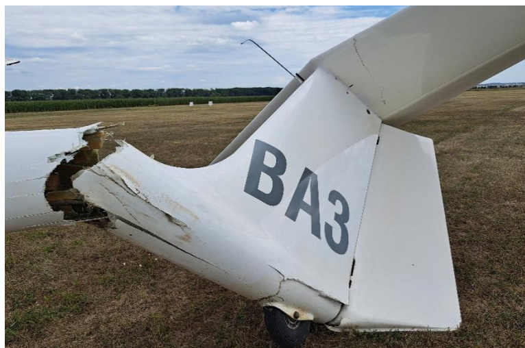
Obr. č. 2 deštrukcia chvostovej rúry
