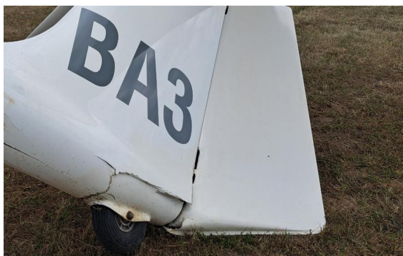
Obr. č. 3 detail na poškodený poťah v mieste uloženia koncového kolieska
