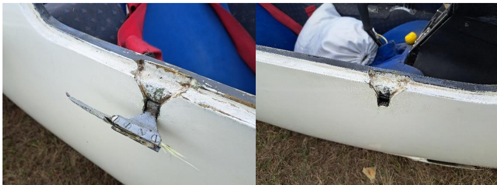
Obr. č. 6 detail na poškodené závesy prekrytu kabíny
