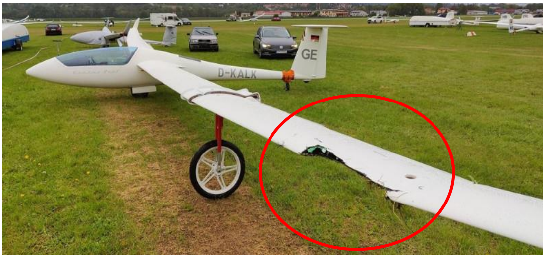
Obr. č. 5 detail na poškodenú nábežnú hranu
