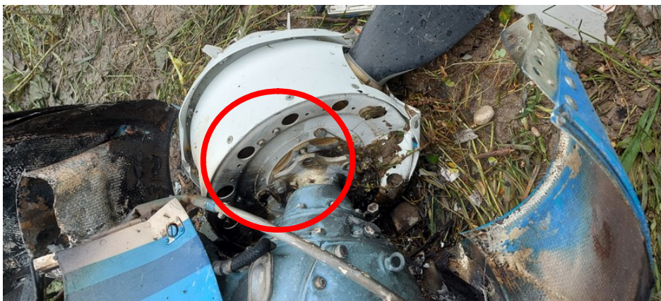
Detail na prírubu spoja vrtule s motorom- vrtuľa čiastočne oddelená
