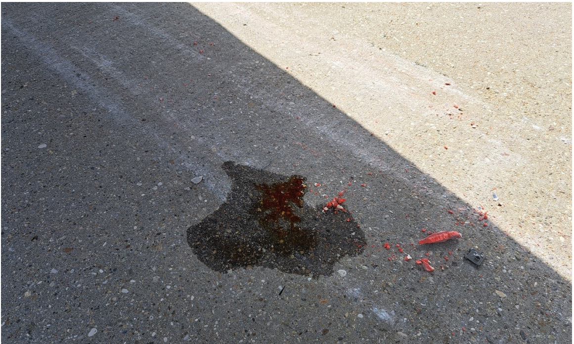
uniknutá hydraulická kvapalina na RWY
