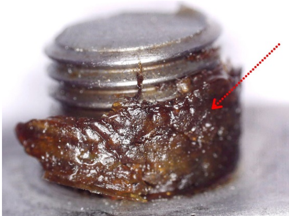
Foto č. 10 tmavý tuhý materiál v blízkosti lomu na skrutke č. 4
