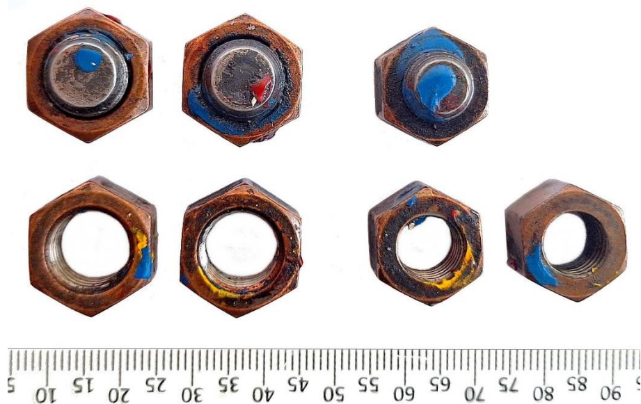
Foto č.6 Horné strany matíc z poškodeného montážneho spoja valca s blokom motora
