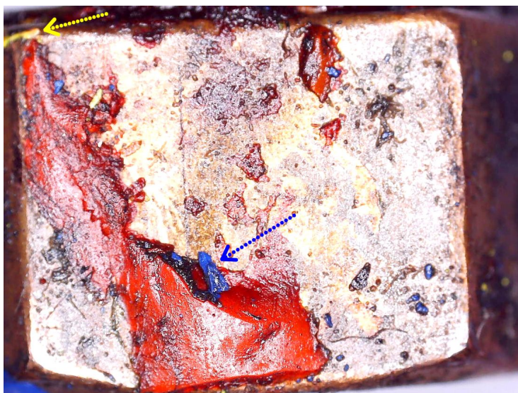
Foto č. 7 Zvyšky materiálov červenej modrej a žltej farby na jednej z predložených matíc
