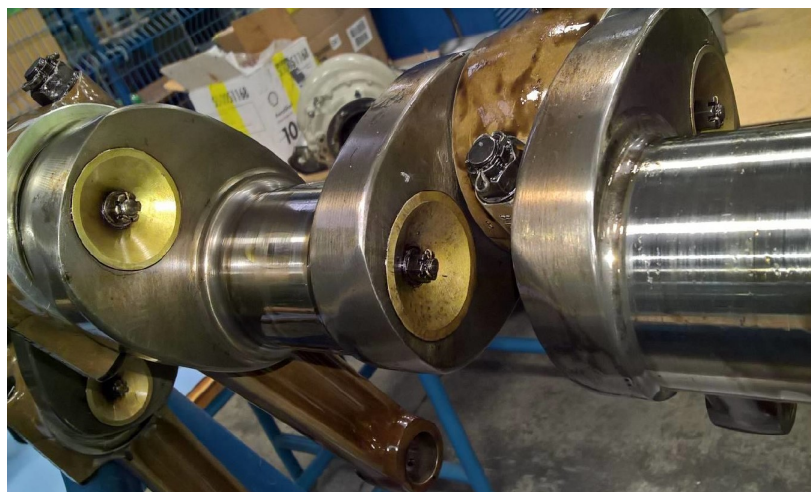
Kľukový hriadeľ s/n 1028 – detail na továrenské informácie a elektroperom vyznačené s/n motora, na ktorom bol kľukový hriadeľ pôvodne namontovaný (60259).
