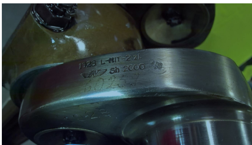
Kľukový hriadeľ s/n 1028 – detail na továrenské informácie a elektroperom vyznačené s/n motora, na ktorom bol kľukový hriadeľ pôvodne namontovaný (60259).
