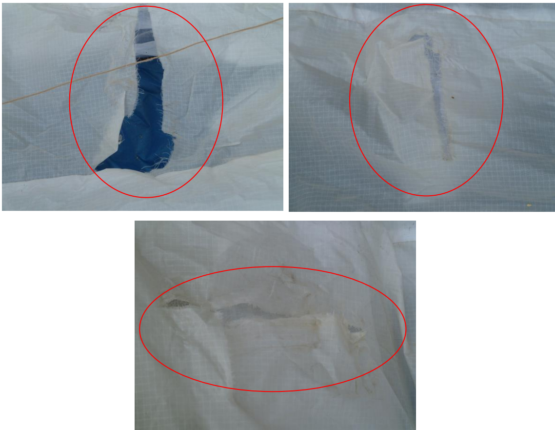
Obr. č. 3 Poškodenie komôr vrchlíka PK po dopade na prekážky
