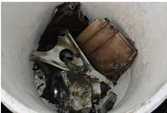
Obr.9 Úlomky komponentov podvozku nájdené na RWY
