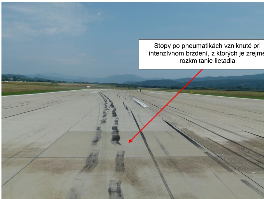
Obr.6 Pohľad na stopy po intenzívnom brzdení
