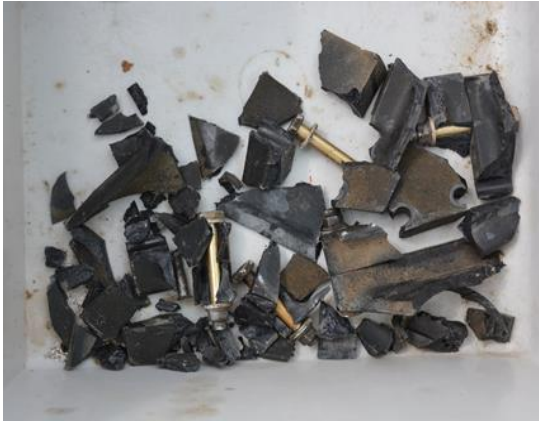
Obr.11 Úlomky komponentov podvozku nájdené na RWY
