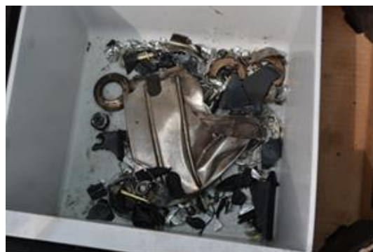
Obr.10 Úlomky komponentov podvozku nájdené na RWY
