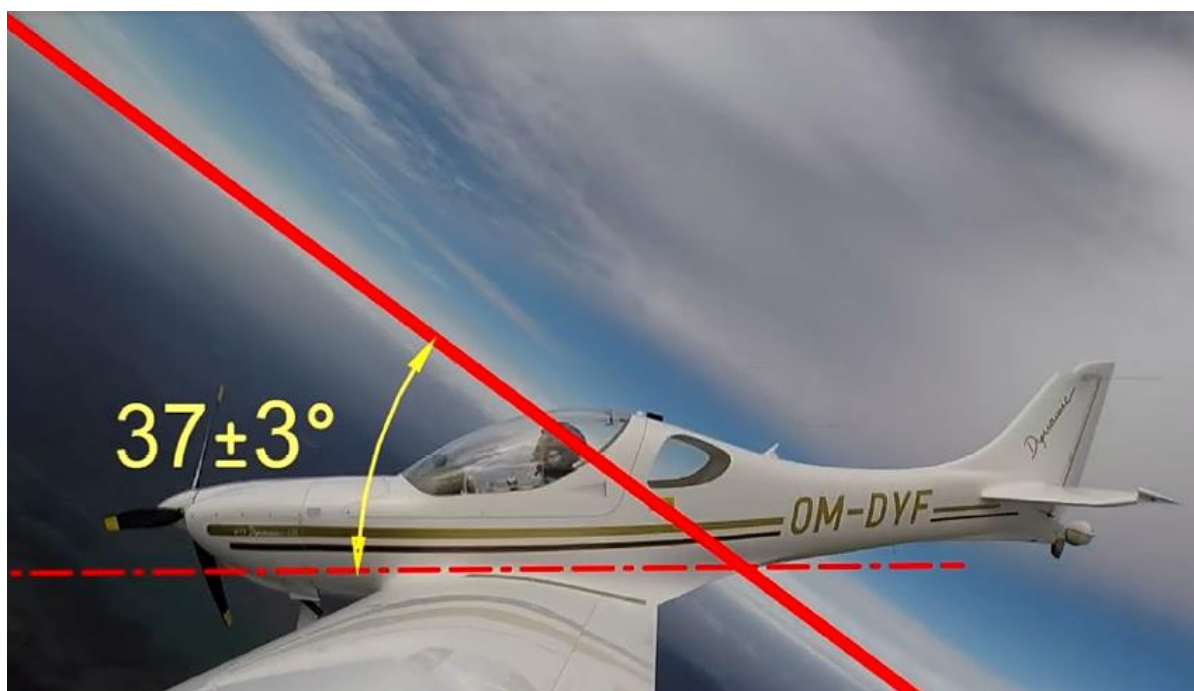
Pozdĺžny sklon letúna v ľavej vývrтке
