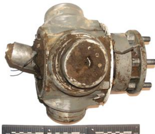
Obr.20 Náboj vrtule predložený ako stopa č.1
