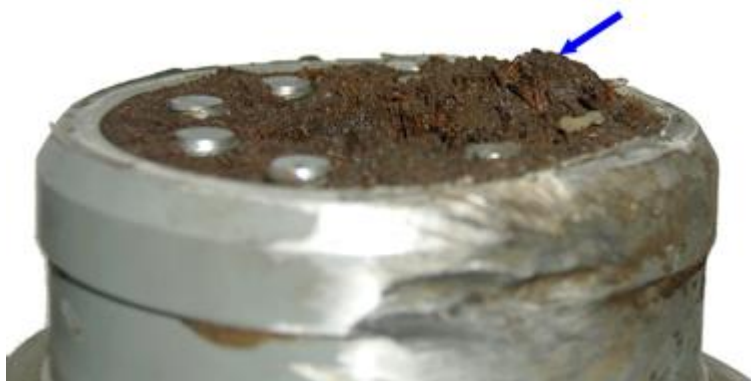
Obr.21 Šikmý pohľad na jednu z lomových plôch odlomenej spodnej časti vrtuľového listu.
