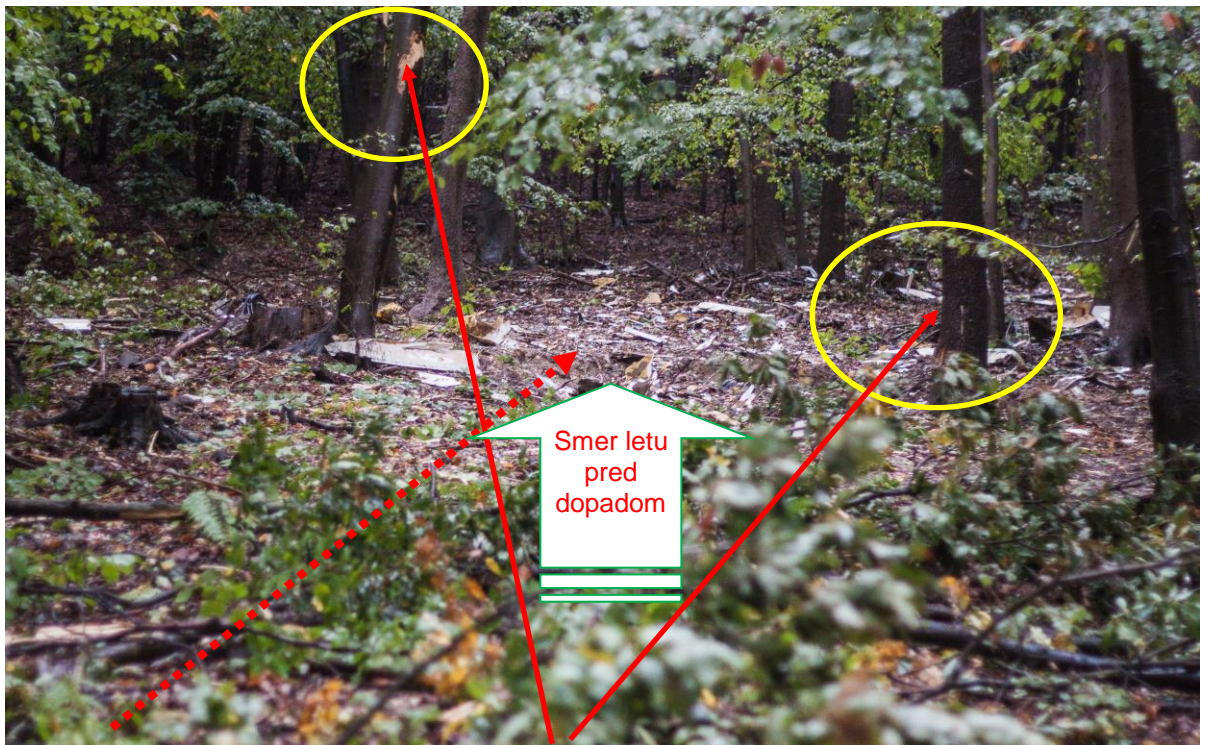
Obr. 15 Poloha motora a stopy krídel pred dotykom s terénom-náklon asi 35°
