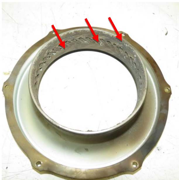
Prstenec obežného kolesa proti smeru prúdenia, nánosy hliny (šípky)
