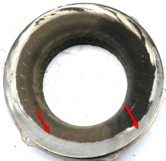
Prstenec obežného kolesa v smere prúdenia, s oterovými stopami (šípky)
