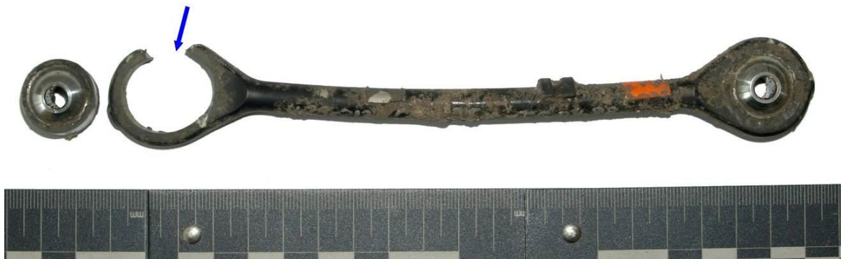
Poškodené tiahlo z mechanizmu natáčania listov zadného rotora
