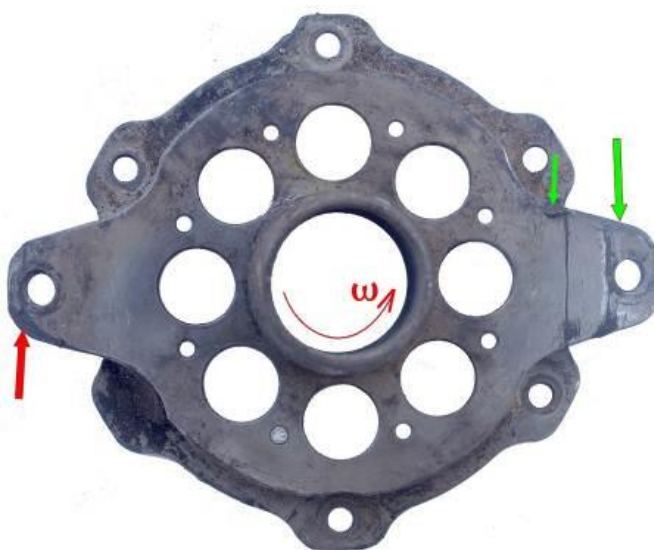
Vstupná príruha vstupnej pružnej spojky pravého hnacieho hriadeľa - šípky označujú hrany poškodené nárazmi príruby do pevnej prekážky
