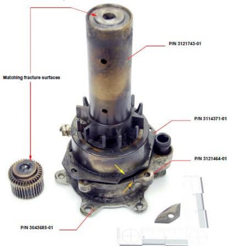
Výstupný hriadeľ a ložisko č.8
