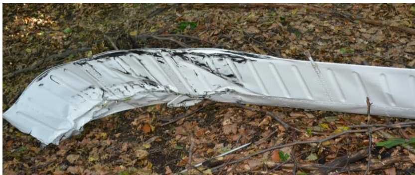
Balančné krídelko pravého krídla OM-SAB so stopami od čiernej nábežnej hrany chvosta OM-ODQ
