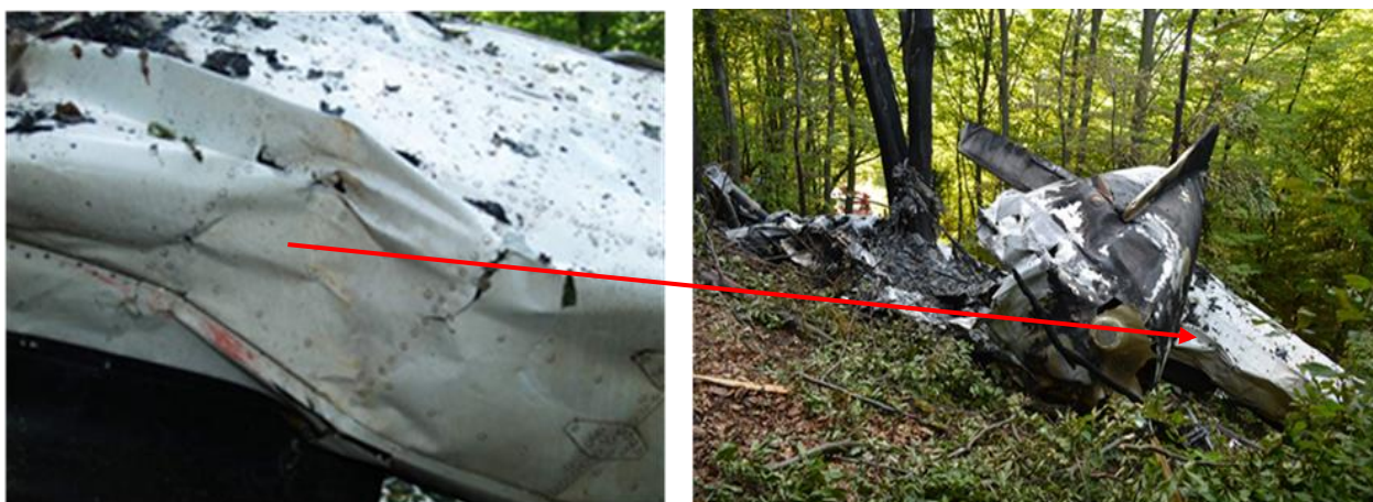
Poškodená časť pravej vodorovnej chvostovej plochy OM-SAB od odtrhnutého chvosta OM-ODQ
