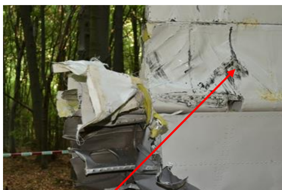
Stopy od lietadla OM-SAB na odtrhnutom chvoste OM-ODQ
