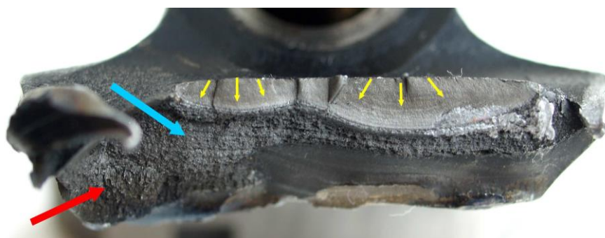
Foto č.2 Dobre čitateľný únavový lom na úlomku ojničnej hlavy
