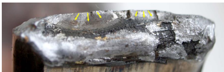
Foto č.3 Zrkadlový obraz lomu na driekovej časti ojnice
