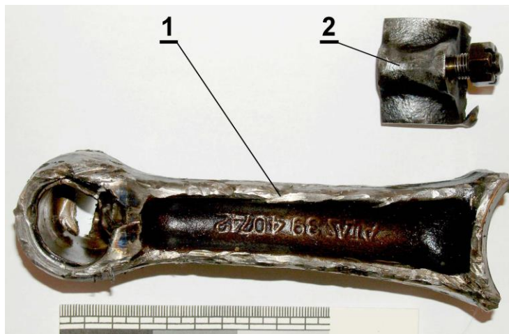
Foto č.1 Predložené časti poškodenej ojnice
