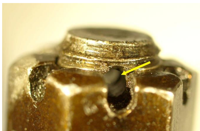
Foto č.6 Chýbajúca poistná závlačka na korunovej matici
