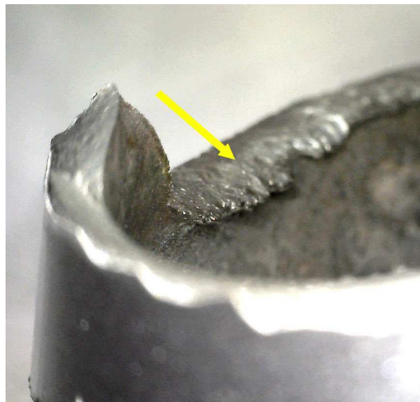
Otláčenie povrchu lomu v oblasti "C"
