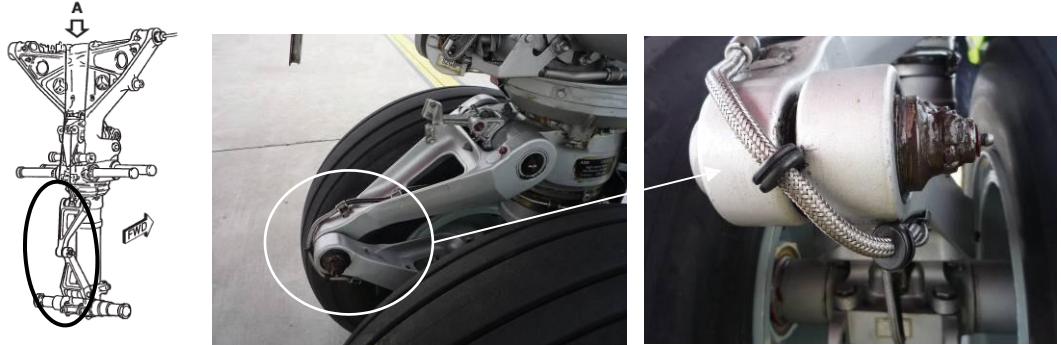
Schéma a fotografie (pohľad z profilu a spredu) spojovacieho segmentu nožnicového mechanizmu predného podvozku A300-B4
