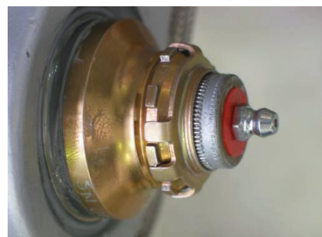
Fotografia koncovej časti hriadeľa s viditeľnými 0,5 mm drážkami za brzdovým krúžkom
