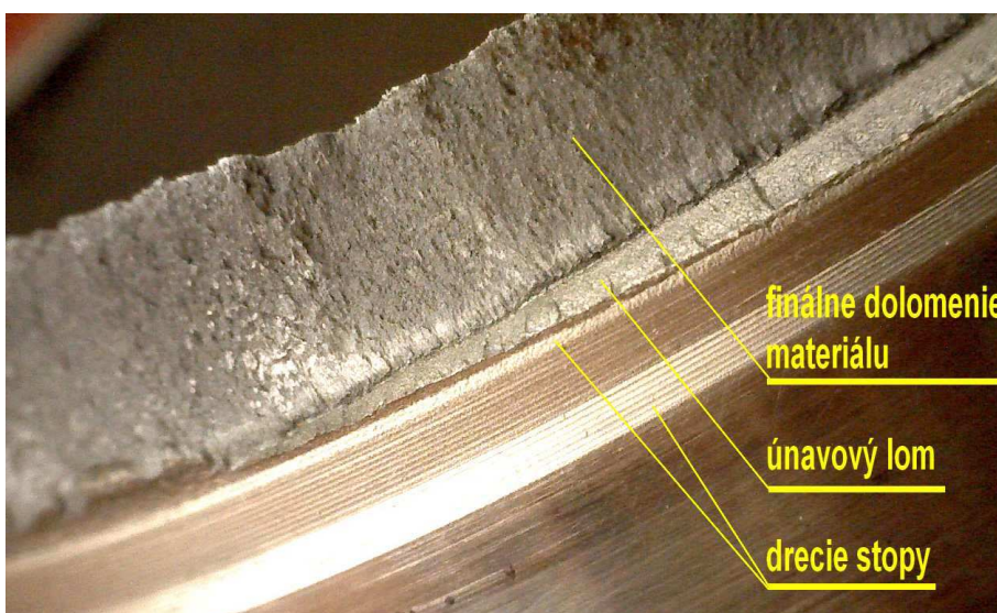
Obr. 4b Protiľahlá menšia časť únavového lomu a strmá oblasť finálneho dolomenia materiálu.
