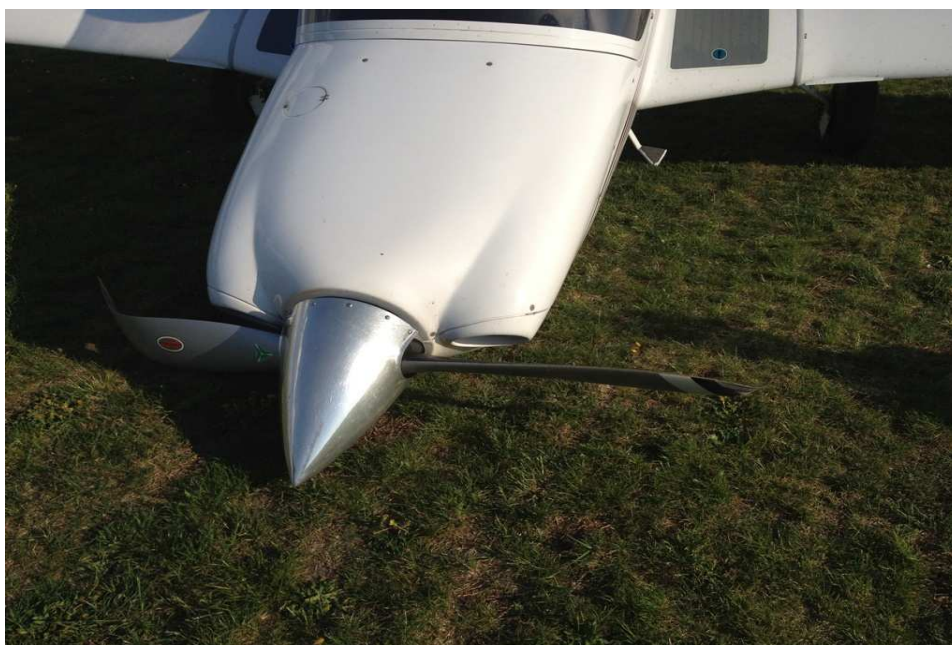
Poškodenie vrtule a motora lietadla násilným zastavením dotykom vrtule s terénom.
