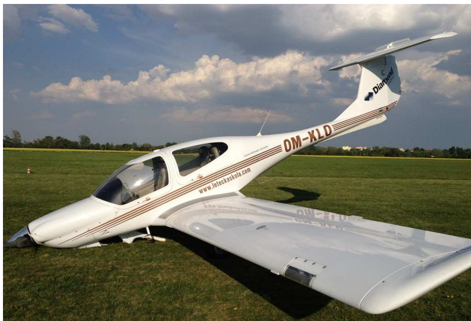
Zlomenie prednej podvozkovej nohy, poškodenie vrtule a motora lietadla
