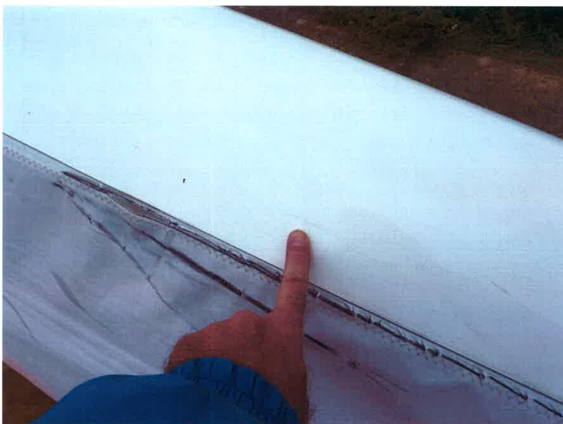
Obr. 2: Poškodenie D-skrine a pot'ahu krídla Phantom MZK
