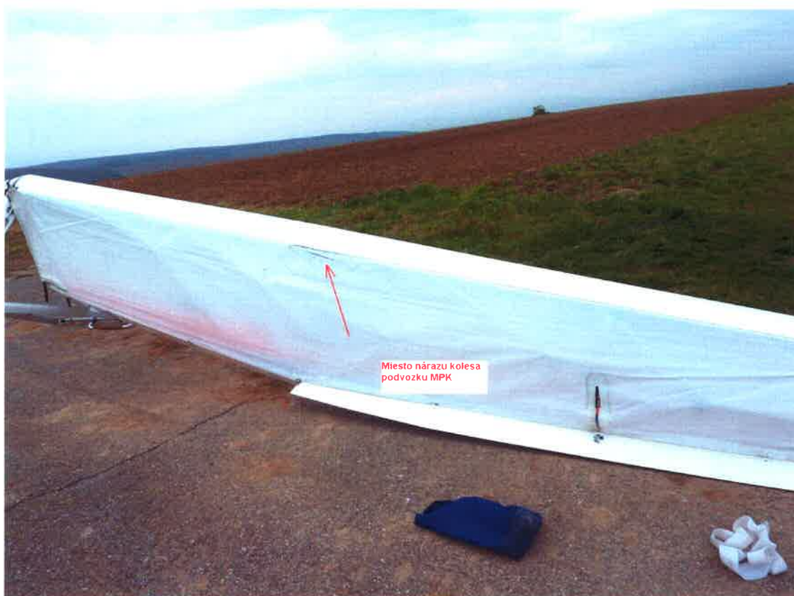
Obr. 1: Krídlo MZK Phantom a miesto nárazu kolesa podvozku
