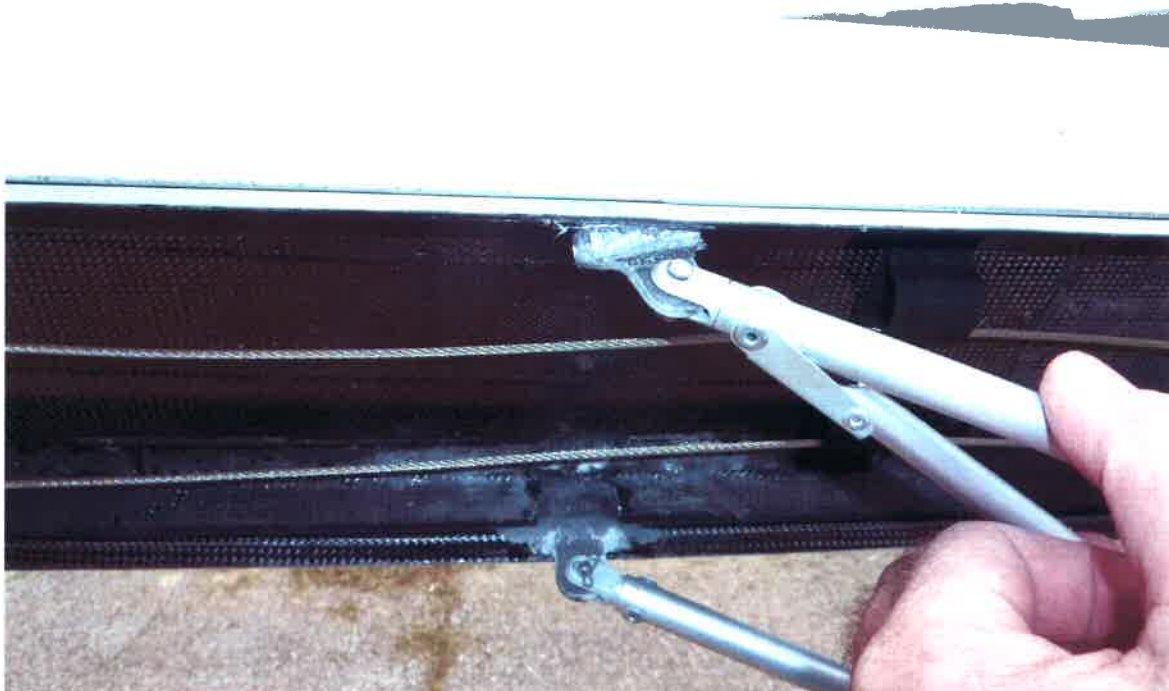
Obr. 3: Poškodenie horného uchytenia rebra krídla Phantom MZK
