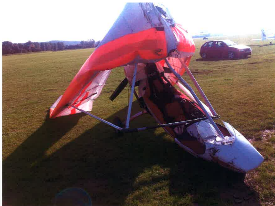
Obr. 1: Poškodenie MZK (foto po ustavení MZK na kolesá podvozku)
