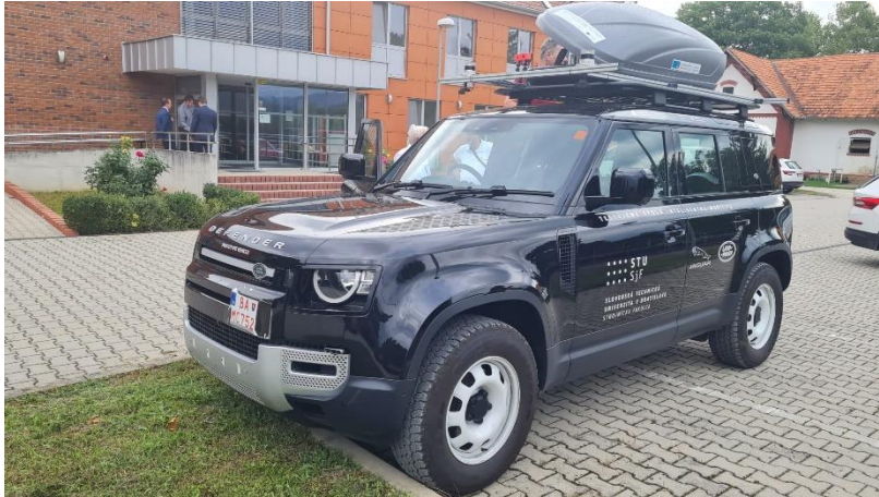
Obrázok 1.: Meracie vozidlo Land Rover Defender s nadstavbou AIL System Solution.
