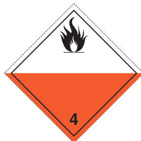
(Vzor 4.2) Symbol (plameň): čierny na bielom (horná polovica) a červenom podklade (spodná polovica), číslica «4» v spodnom rohu
